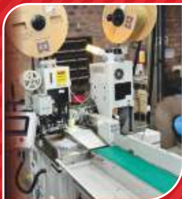
MÁQUINA CORTA, DECAPA FIOS E CRIMPA TERMINAIS
