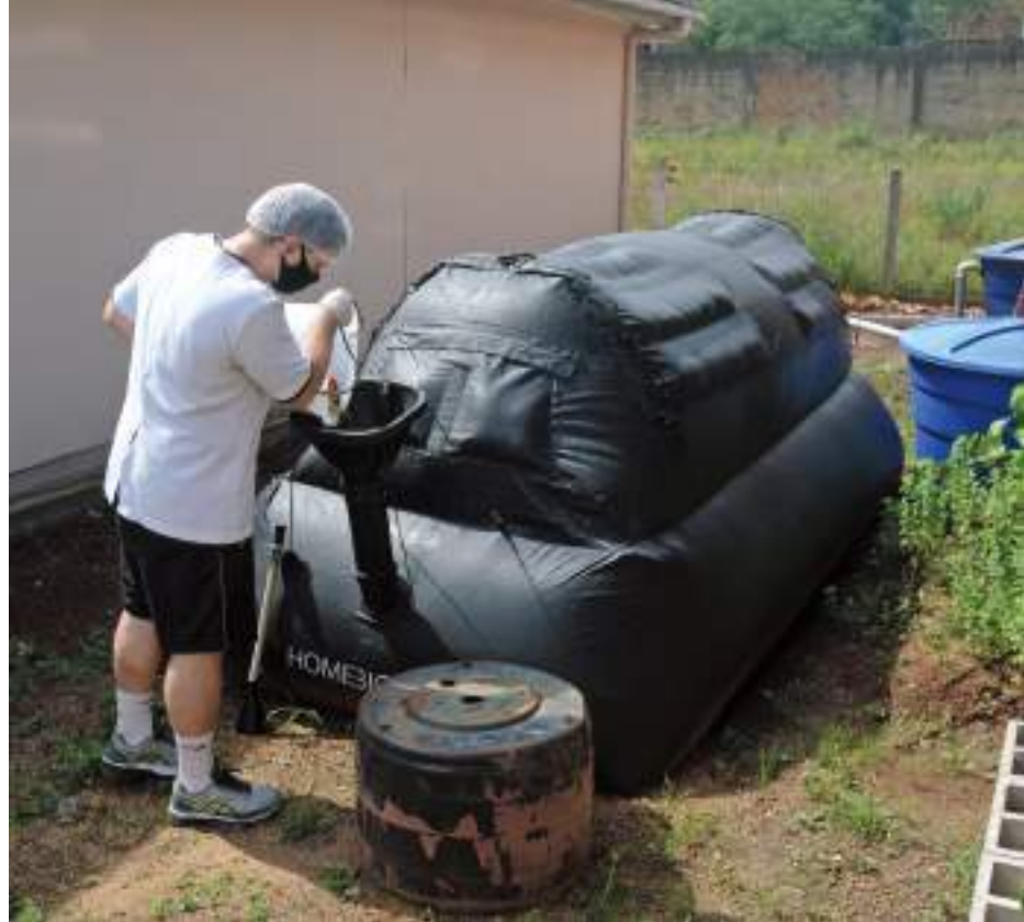
ESCOLAS RECEBERAM BIODIGESTORES, POR MEIO DOS QUAIS RESÍDUOS ORGÂNICOS SE TRANSFORMAM EM BIOGÁS E FERTILIZANTE
